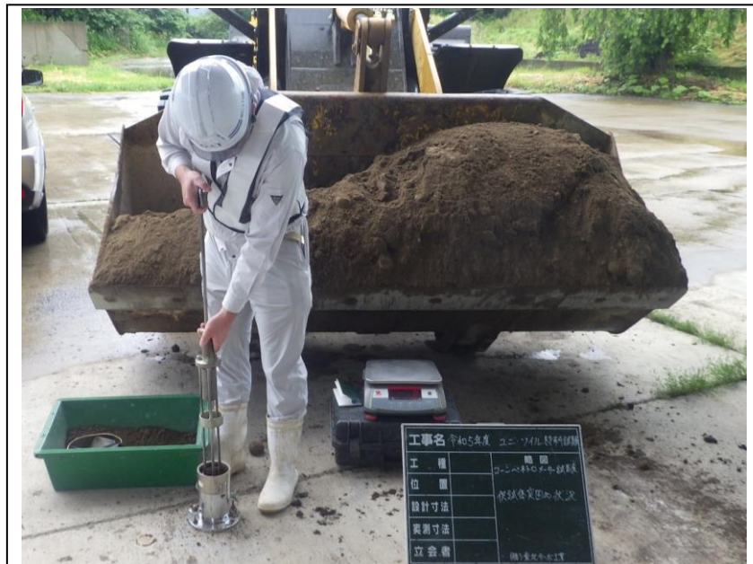
供試体突固め状況
